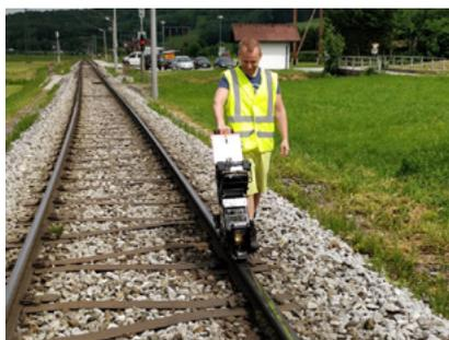
*Contrôle par courant de Foucault et ultrasons (image de droite).*
