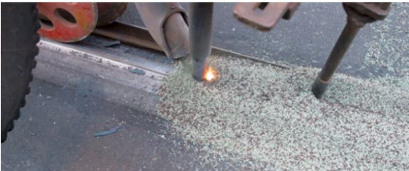
*Das Unterpulverschweißen ermöglicht bei professioneller Handhabung spritzerfreie Nähte von sehr hoher Qualität.*
