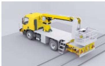
2. Une commande hydraulique permet d'abaisser le bogie sur le rail et l'extrémité arrière du véhicule est soulevée au-dessus de la route.
