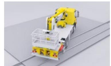
3. Les roues routières avant du véhicule sont tournées de façon à suivre le mouvement du véhicule lorsque le bogie arrière est dirigé vers l'arrière, pour amener le véhicule sur le rail. Le véhicule peut ainsi suivre une ligne courbe sans jamais empiéter sur un rail adjacent.
