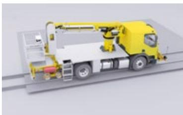
4. Lorsque le véhicule a fini sa marche arrière et qu'il a atteint sa position sur le rail, les roues ferroviaires avant sont placées juste au-dessus du rail. Une commande hydraulique abaisse les roues ferroviaires avant sur le rail et relève les pneus avant du passage à niveau.
