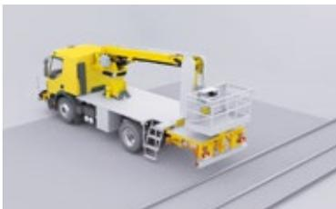
1. Pour passer sur rail, le véhicule rail-route de SRS recule vers les rails de sorte que l'extrémité arrière du bogie ferroviaire se trouve suspendu au-dessus du rail.
