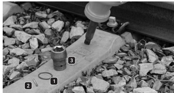
Abbildung 30: Wechsel des Steckschlüsseinsatzes
