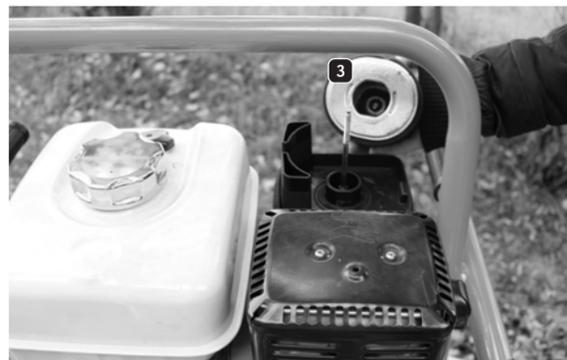
Abbildung 38: Schaumfilterelement abnehmen
