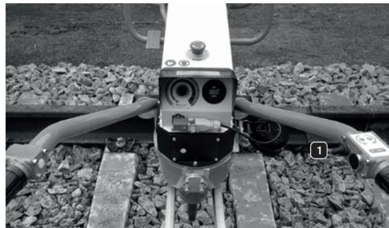
Abbildung 26: Drehrichtungswähler
