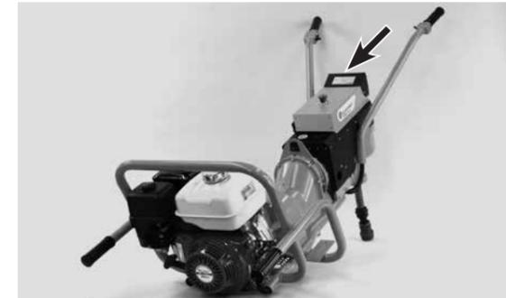
Abbildung 2: Anbringungsort Typenschild
