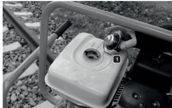
Abbildung 32: Relevante Elemente zum Auffüllen von Kraftstoff
