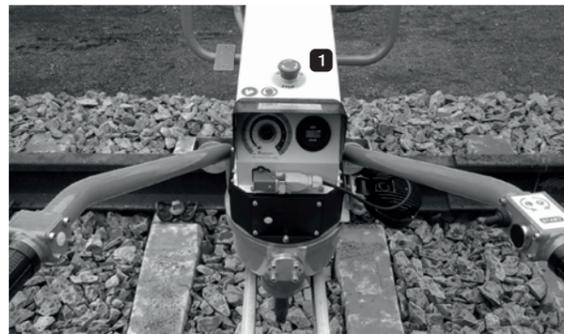
Abbildung 27: Maschinenstopp im Notfall
