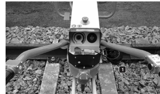
Abbildung 31: Position Arbeitsbeleuchtung
