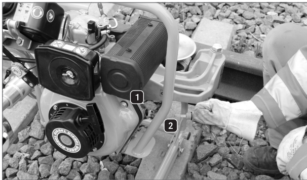
Abbildung 28: Öl auffüllen – GP 4000 D
