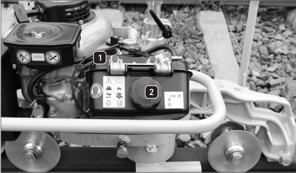
Abbildung 26: GP 4000 D – Diesel auffüllen 1
