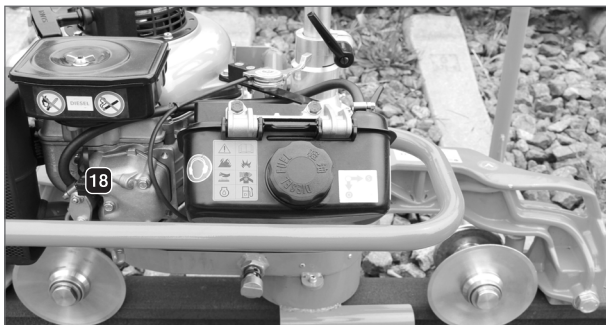
Abbildung 22: Öleinfüllverschluss für den Kaltstart
